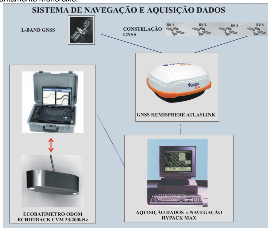
Figura 2.2: Representação esquemática do sistema de navegação e aquisição para levantamento monofeixe.
