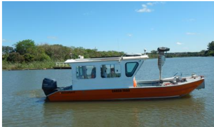
Figura 2.3: Barco hidrográfico com multifeixe Reson T50-P instalado na proa com braço basculante para rápido posicionamento em configuração operacional.
