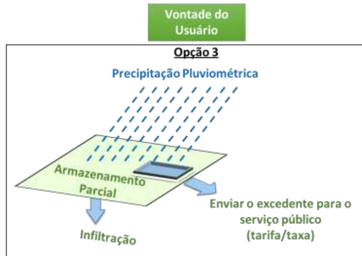
Figura 6 - Opção 3 para escoamento das águas pluviais.
