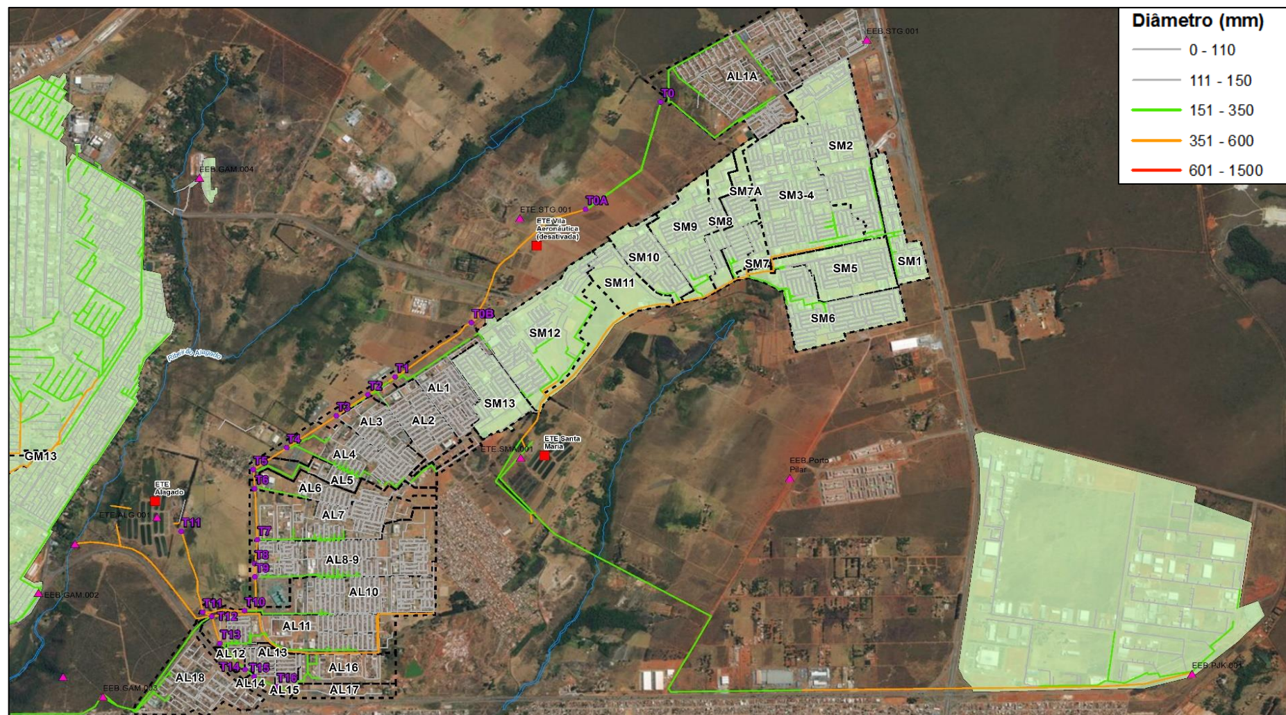
Figura 1 - Divisão das sub-bacias e do interceptor, localização das elevatórias e estação de tratamento existentes - Sistema ETE Alagado.
