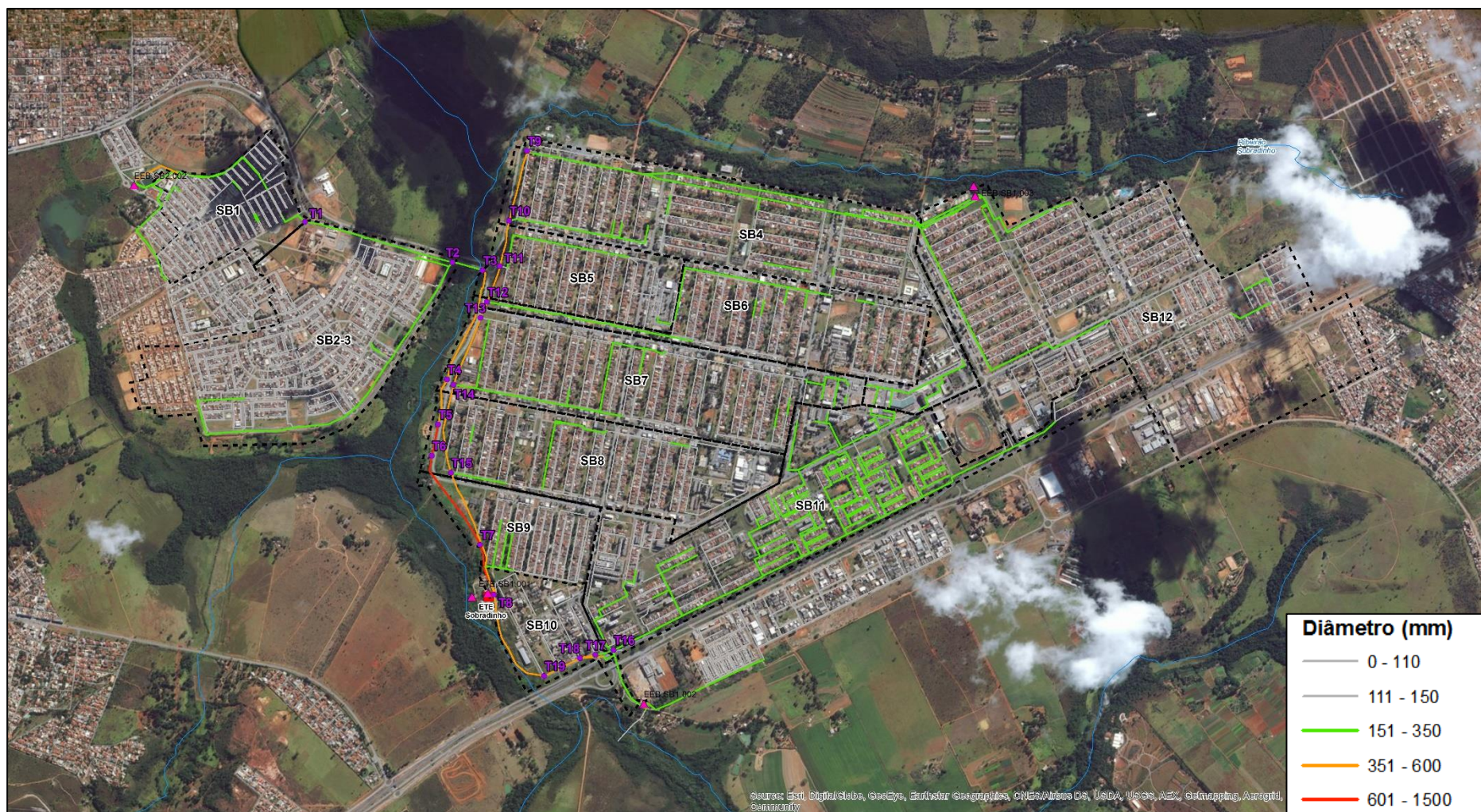
Figura 15 - Divisão das sub-bacias e do interceptor, localização das elevatórias e estação de tratamento existentes - Sistema Sobradinho.
