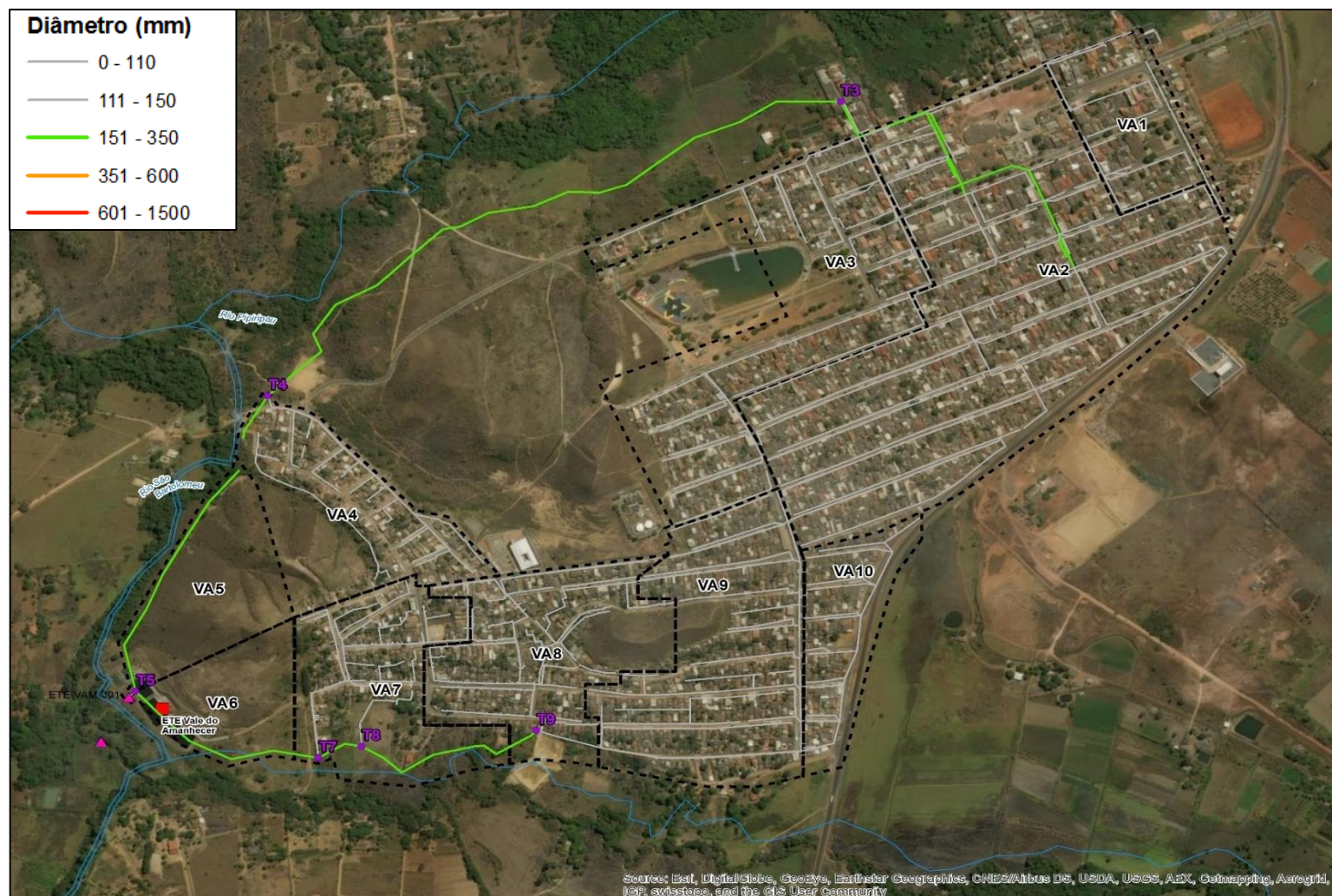
Figura 17 - Divisão das sub-bacias e do interceptor, localização das elevatórias e estação de tratamento existentes - Sistema Vale do Amanhecer. Fonte: SERENCO.
