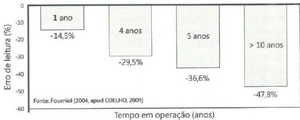
Figura 93 - Erros de medição de hidrômetros resultantes dos ensaios de hidrômetros domiciliares velocimétricos em uma rede de distribuição de Maceió sem intermitência.
