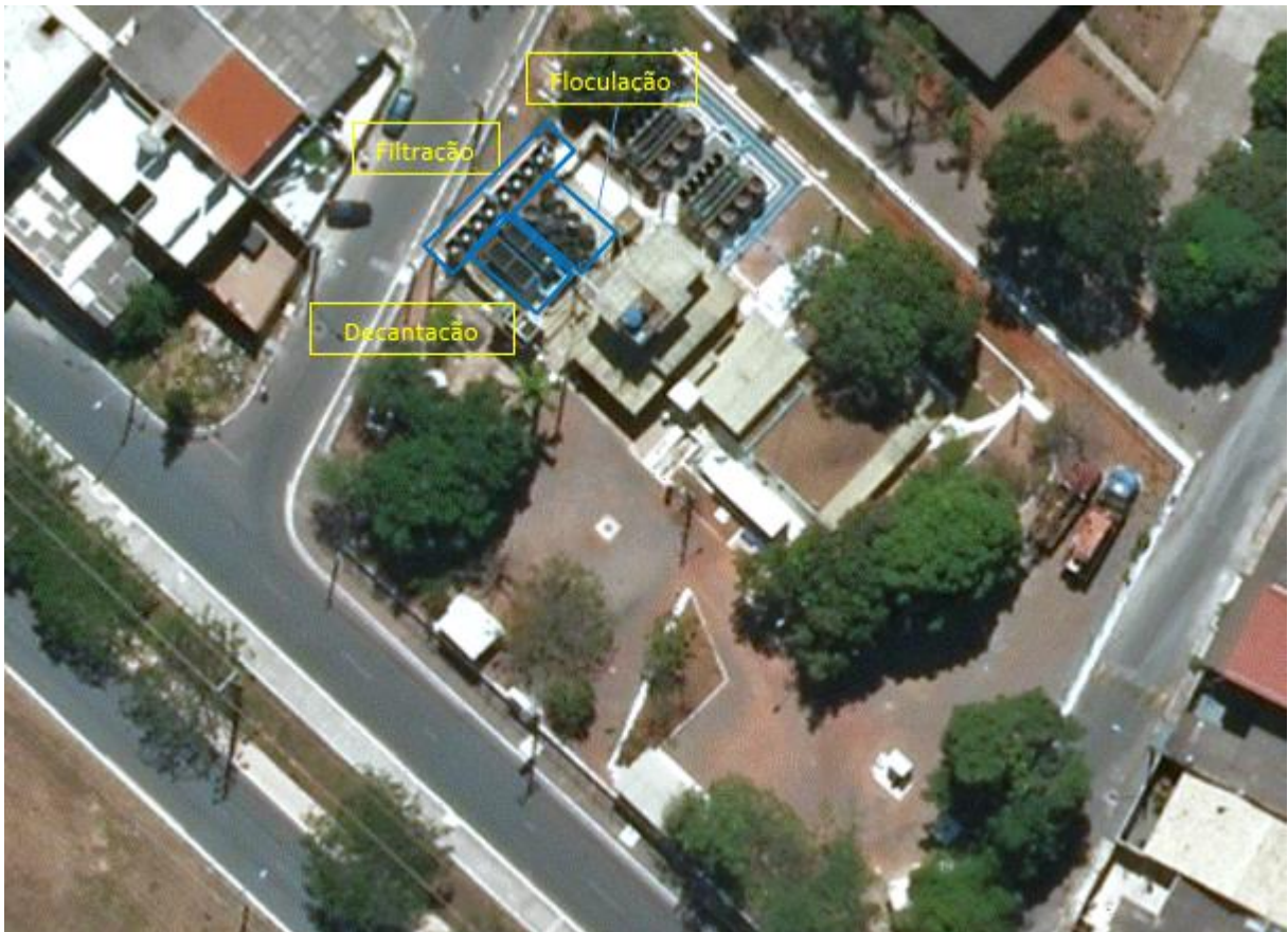
Figura 11 - Vista aérea da ETA Paranoá. Fonte: Adaptado do Google Earth, 2016.
