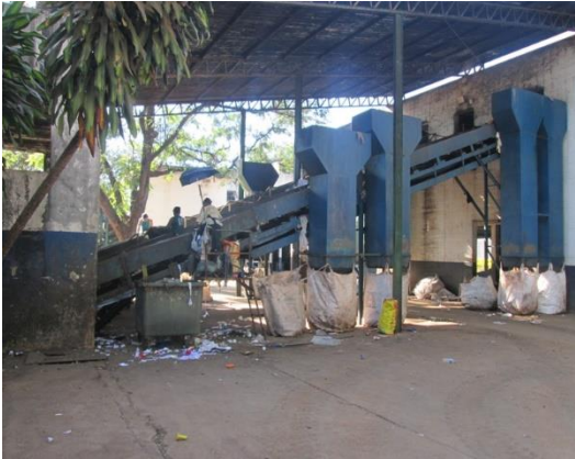
Figura 106 - Esteira inclinada adaptada para triagem e digestor rotativo - UTMB Asa Sul.
