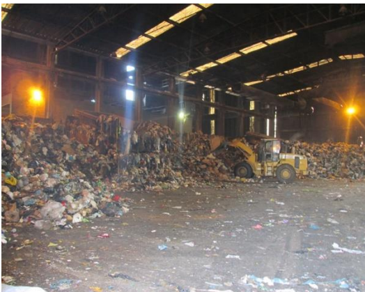
Figura 107 - Local de entrada dos resíduos e alimentação da peneira rotativa primária na UTMB. Fonte: SERENCO.
