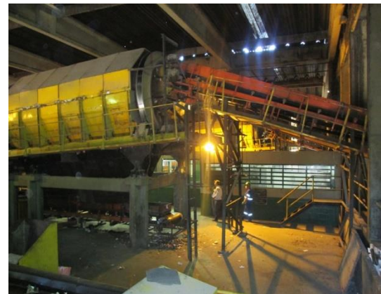
Figura 107 - Local de entrada dos resíduos e alimentação da peneira rotativa primária na UTMB. Fonte: SERENCO.
