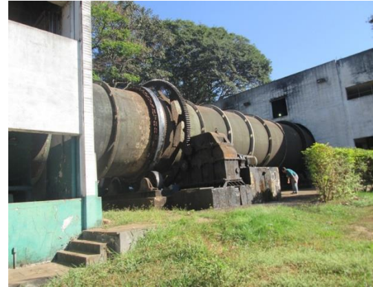
Figura 106 - Esteira inclinada adaptada para triagem e digestor rotativo - UTMB Asa Sul.
