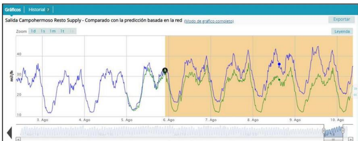
Figura 39 - Detecção de mudanças de padrão, indicando o início de um novo vazamento.
