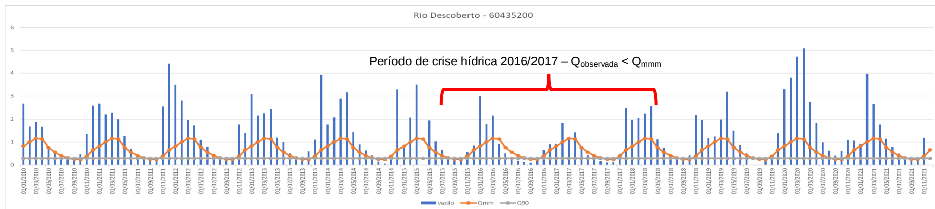
Figura 2.8 - Vazões médias mensais em dois dos principais pontos de monitoramento do Rio Descoberto, com destaque para o período de crise hídrica. Fonte: Diagnóstico do PGIRH
