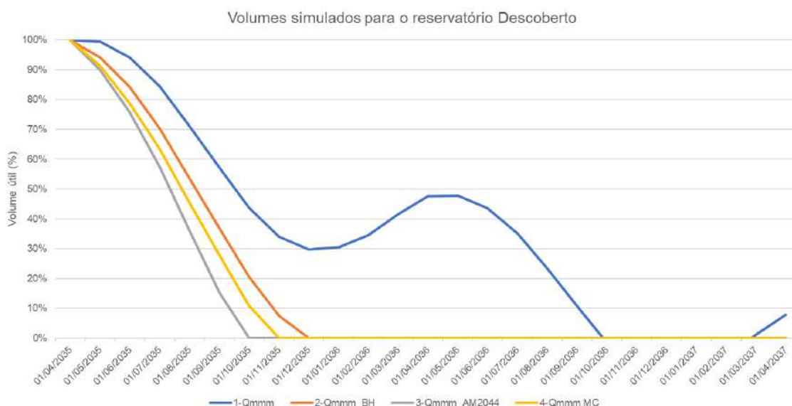
Figura 2.10 – Resultado das simulações dos volumes do reservatório Descoberto para datas hipotéticas
