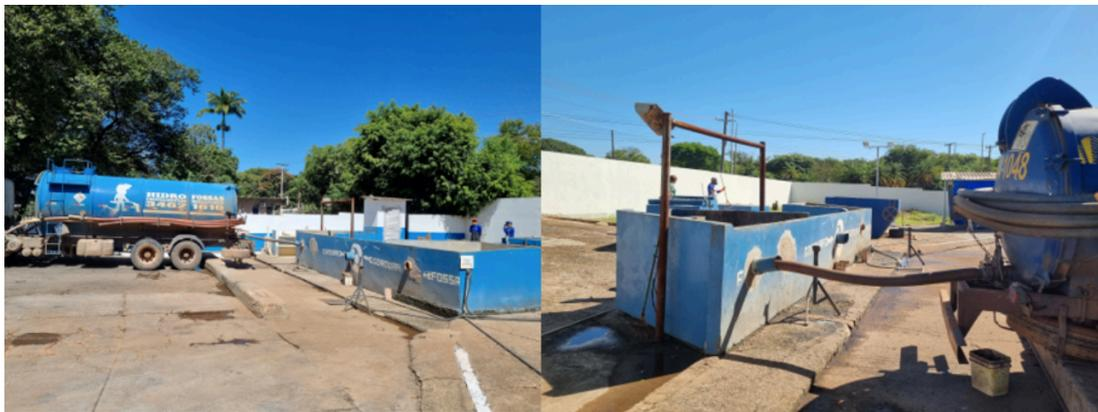
**Figuras 9 e 10:** Caminhão limpa fossa em processo de descarte, na unidade da ETEB Sul; Detalhe do mangote no local destinado ao descarte para lodo de fossas.
