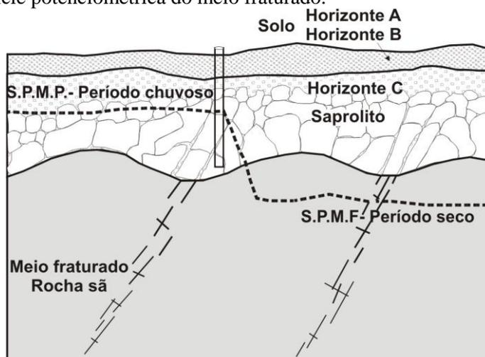
**Figura 2.8** - Ilustração do Modelo de Única Superfície Potenciométrica sem confinamento. Nesse caso, o nível freático apresenta ampla oscilação anual e pode ser observado em solo ou rocha fresca. Condição comum quando ocorrem quartzitos em bordas de chapadas.
