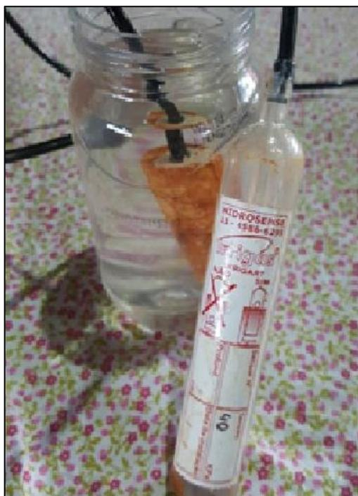
Figura 27 - Equipamento Irrigas.
