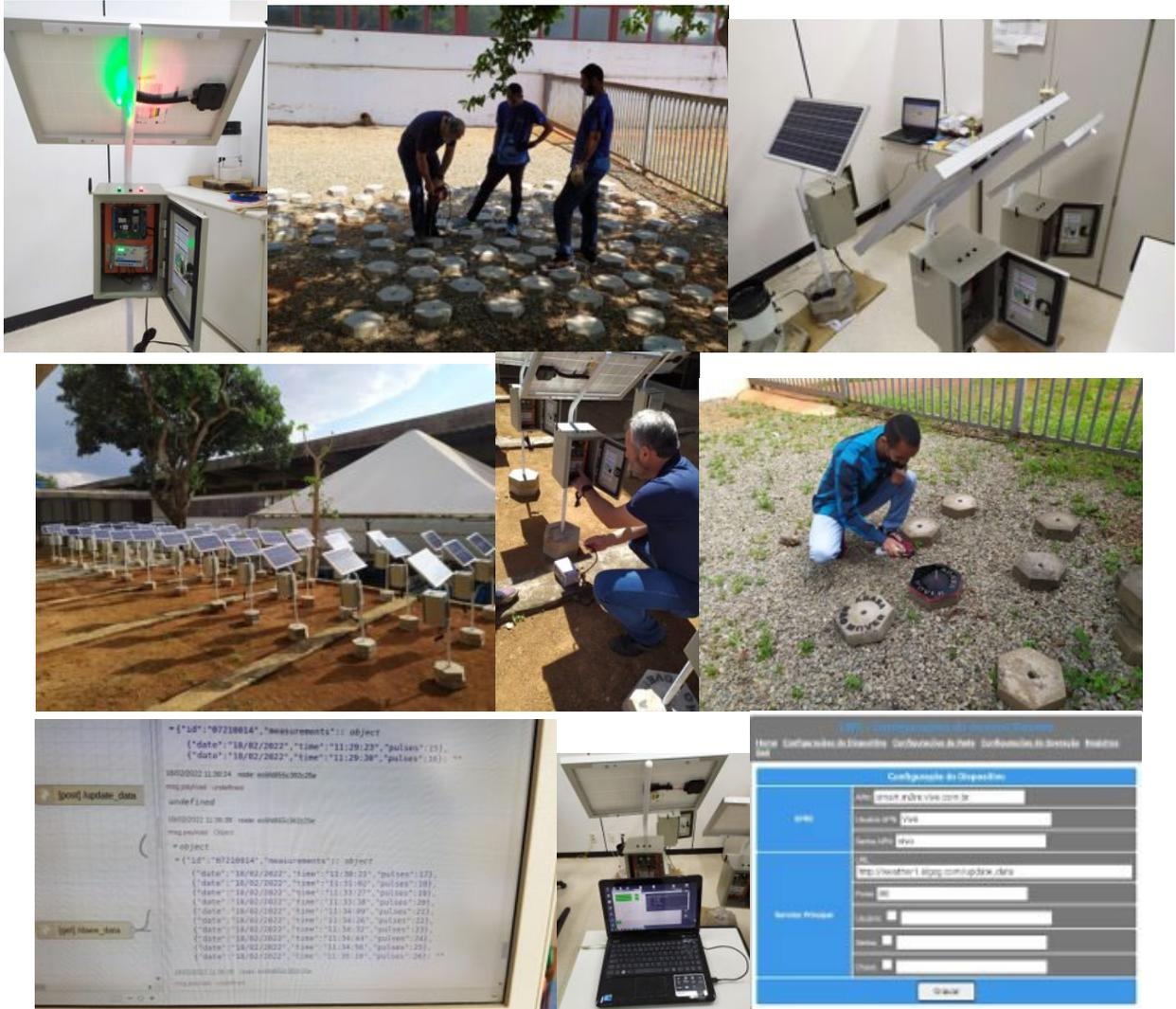
**Figura 12** – Mosaico com imagens das diversas etapas concluídas – preparação, ajustes e testes dos dataloggers telemétricos e de transmissão de dados.
