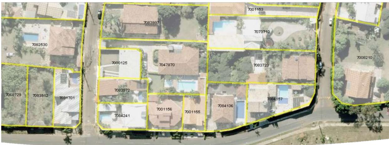
**Figura 5** – Amostra do levantamento das áreas urbanas impermeabilizadas e não impermeabilizadas.
