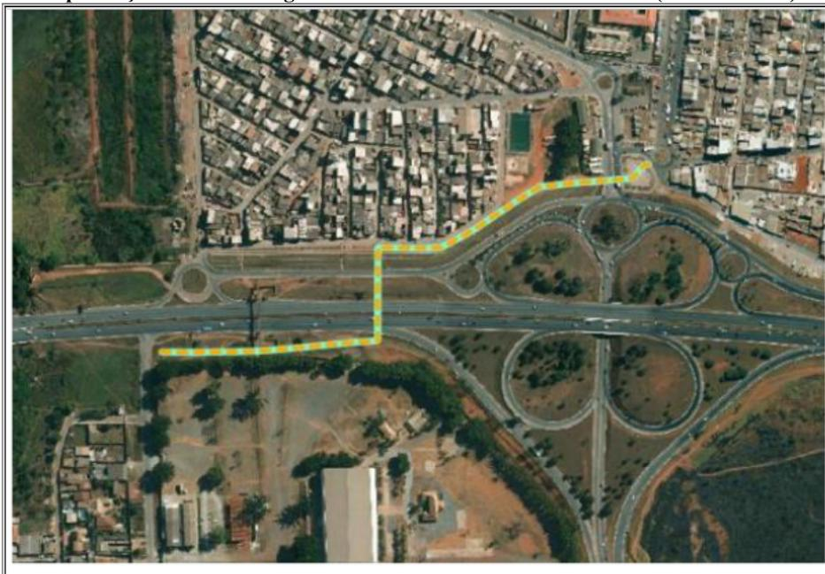
7.10. Quanto às melhorias na SAT.TAG.011: Conhecida como “Adutora Reversível”, é uma das mais relevantes subadutoras por ser a responsável pela integração dos dois principais sistemas de abastecimento. É de ferro fundido, construída na década de 70, possui cerca de 19 km de extensão com diâmetros de DN 1000 mm até a derivação para o Guará I e II, e de DN 700 mm no restante do trecho, tendo grande parte de seu traçado margeando a rodovia EPTG (DF-085) e EPIG.
