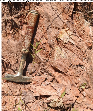
Figura 4.16: Afloramento de filito micáceo alterado – Unidade F (Gr.Canastra) – rodovia BR-251 – Bacia do rio São Bartolomeu. Autoria: ANDRÉ BONACIN/ENGEPLUS.
