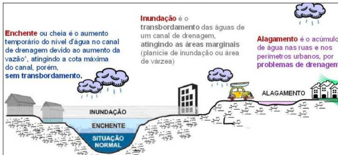
Figura 10.40: Esquema para distinguir tipos de escoamento e acúmulo superficial de água. F. Fonte: NASCIMENTO, 2014.
