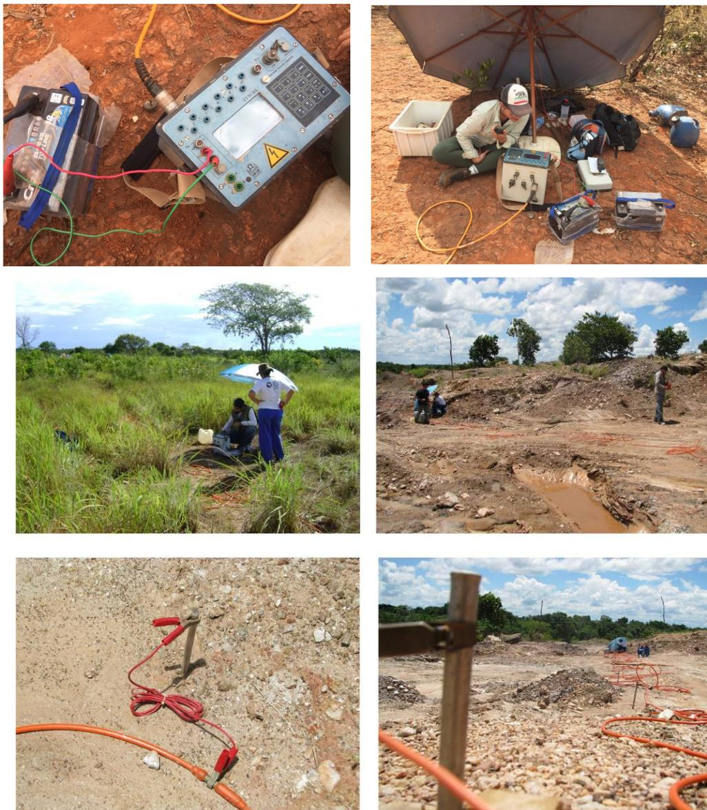
**Figura 13** - Fotografias exemplificando a aquisição de dados de Eletroresistividade ao longo de perfil pré-estabelecido.
