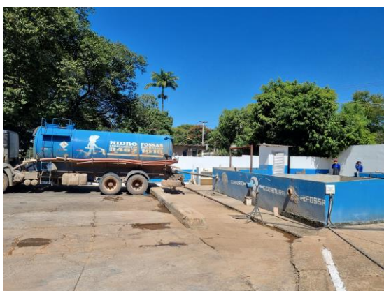
Figura 19 | Caminhão limpa-fossa em processo de descarte, na unidade da ETEB Sul.
