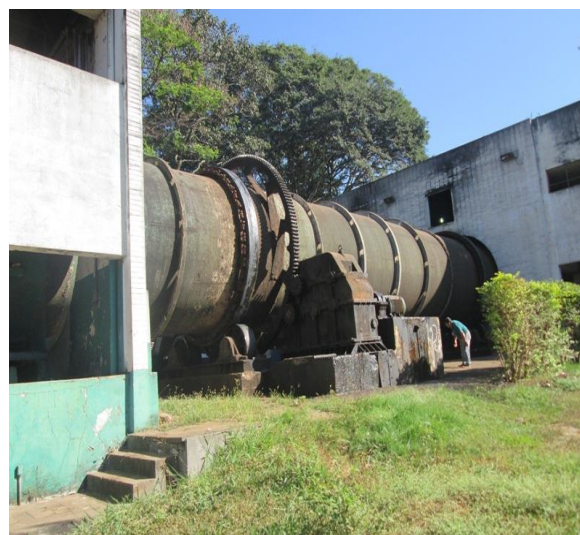
Figura 29 - Esteira inclinada adaptada para triagem e digestor rotativo - UTMB Asa Sul.
