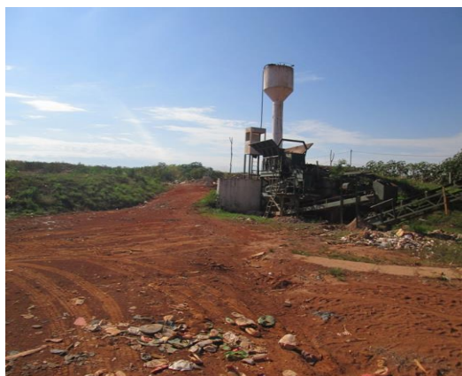
Figura 62- Britador de RCC dentro do Aterro do Jóquei.
