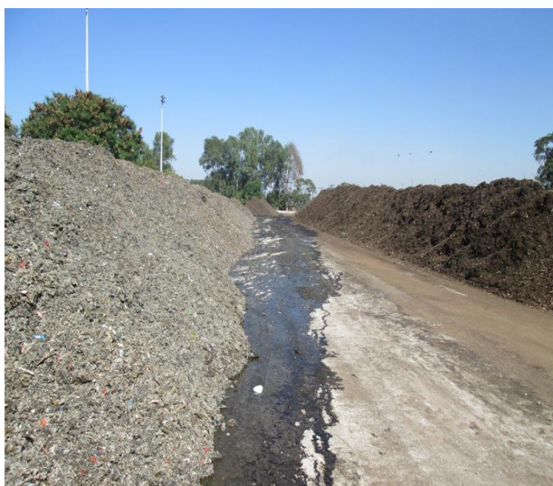
Figura 31 - Leiras de compostagem e composto peneirado.
