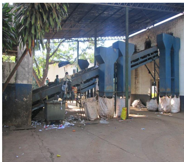
Figura 29 - Esteira inclinada adaptada para triagem e digestor rotativo - UTMB Asa Sul.
