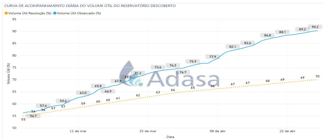
Figura 80. Comparação entre o volume útil definido pela Resolução ADASA nº 03/2018 e o volume útil observado para o reservatório Descoberto.
