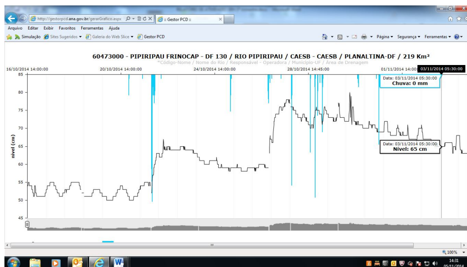
Figura 34. Tela de acompanhamento de chuvas e nível da estação Pipiripau pelo Gestor PCD
