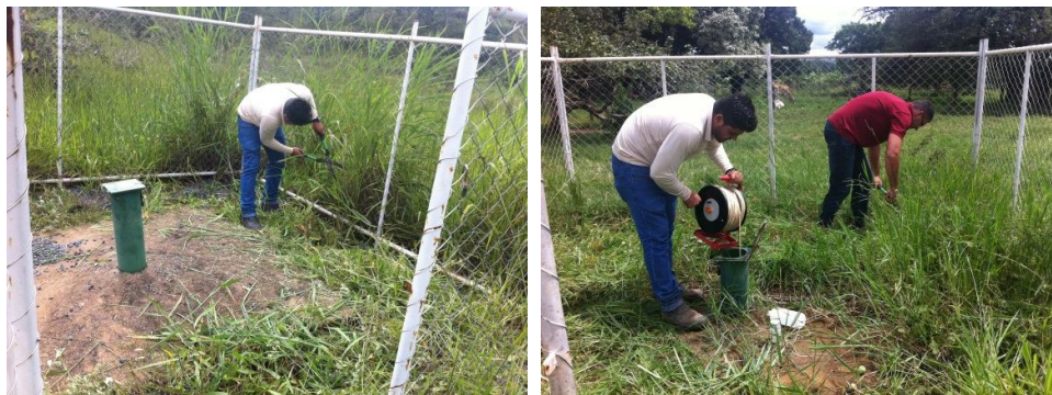
Figura 35. Poda, coleta de água para análise de qualidade e medição de nível estático
