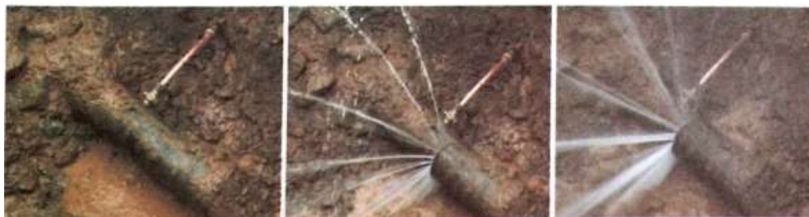
Figura 15 - Influência da pressão em um vazamento.
