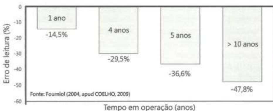
Figura 13 - Erros de medição de hidrômetros resultantes dos ensaios de hidrômetros domiciliares velocimétricos em uma rede de distribuição de Maceió sem intermitência.
