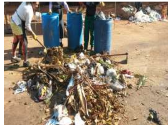
Figura 19 - Acondicionamento da amostra a ser analisada em tambores.
