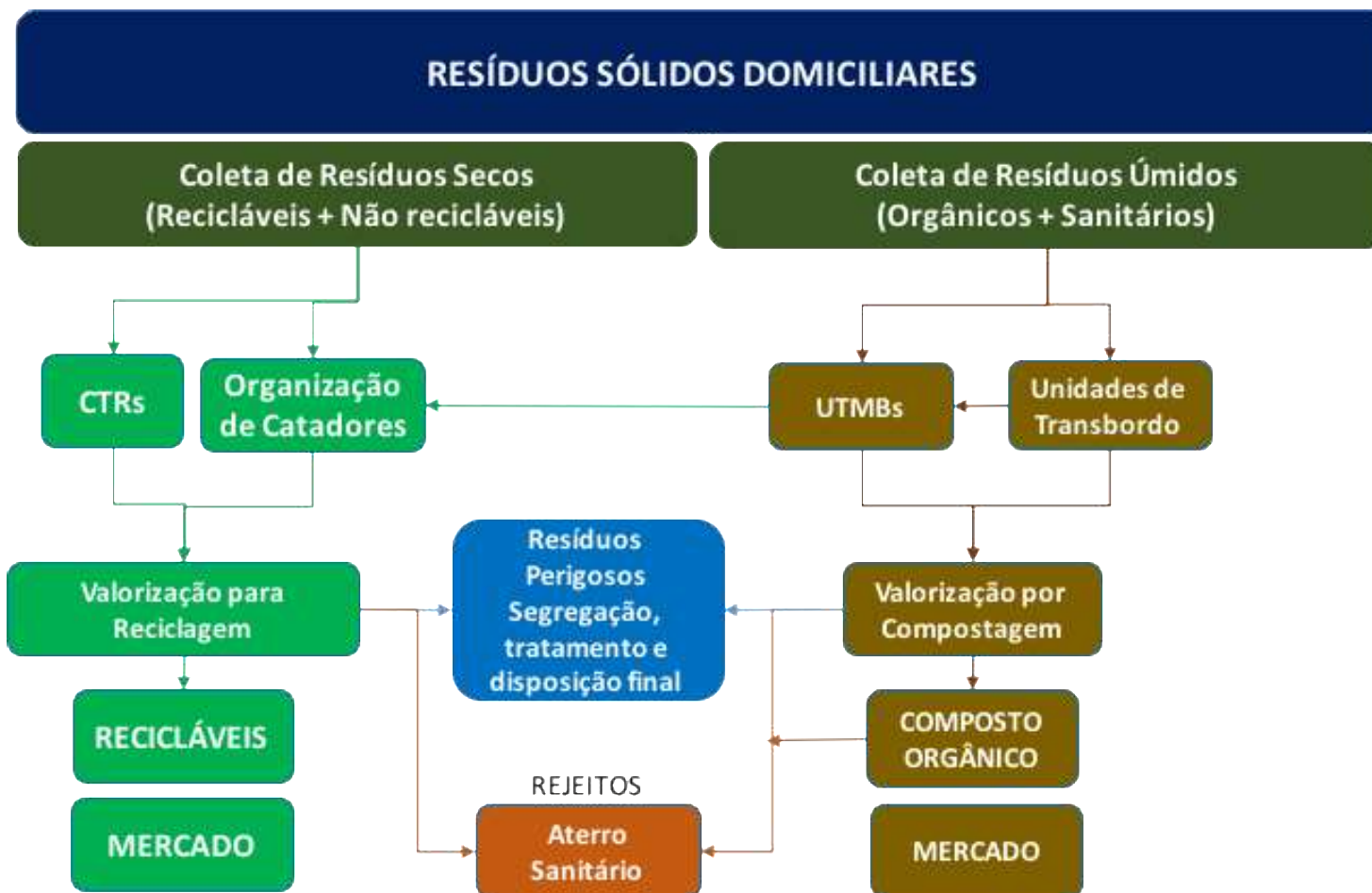
Figura 8 - Modelo de manejo de Resíduos Domiciliares para o Distrito Federal - Proposta SEMA-DF. Fonte: SERENCO.
