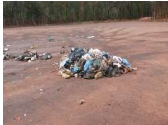
Figura 18 - Novo quartejamento da amostra e escolha da amostra para caracterização.
