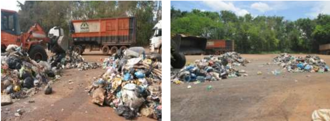
Figura 15 - Amostra dividida em quatro partes. Fonte: SERENCO.
