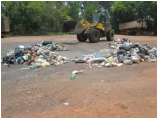
Figura 18 - Novo quartejamento da amostra e escolha da amostra para caracterização.
