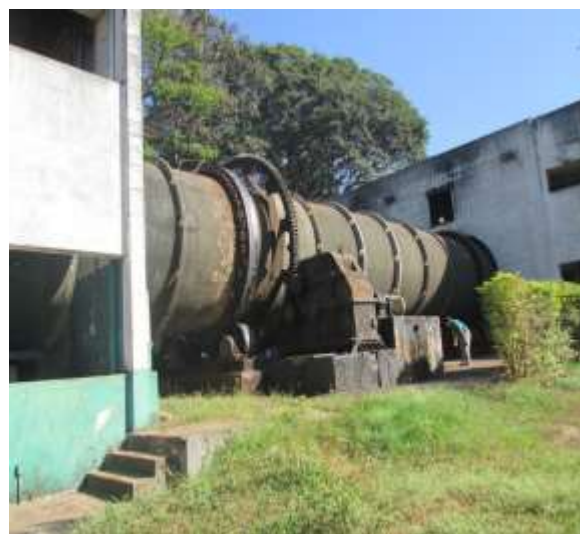
Figura 36 - Esteira inclinada adaptada para triagem e digestor rotativo - UTMB Asa Sul. Fonte: SERENCO.
