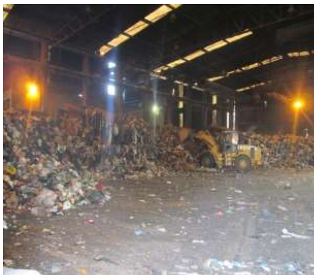
Figura 37 - Local de entrada dos resíduos e alimentação da peneira rotativa primária na UTMB.
