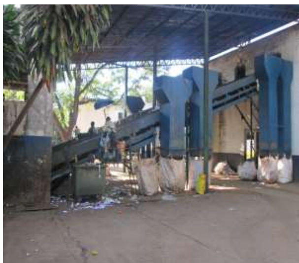
Figura 36 - Esteira inclinada adaptada para triagem e digestor rotativo - UTMB Asa Sul. Fonte: SERENCO.
