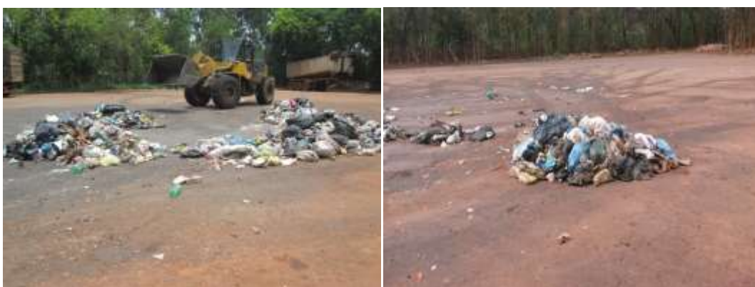
Figura 94 - Novo quarteamento da amostra e escolha da amostra para caracterização.
