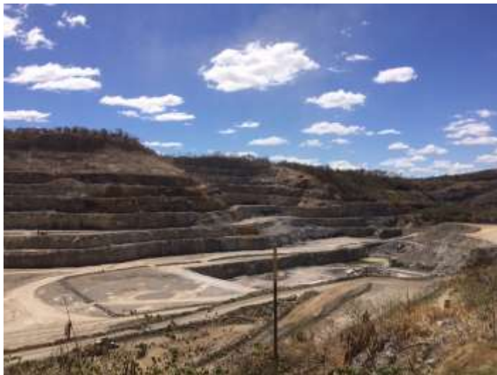
Figura 102 - Jazida de calcário e argila com camadas de material estéril.
