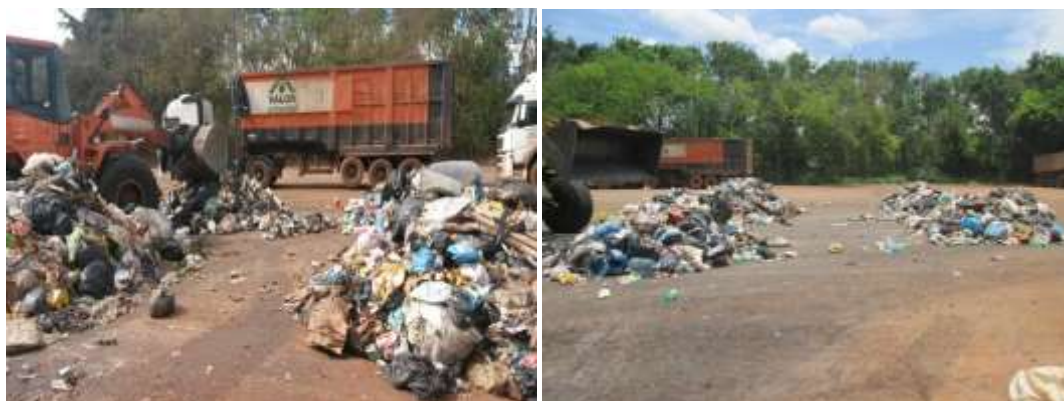
Figura 91 - Amostra dividida em quatro partes.
