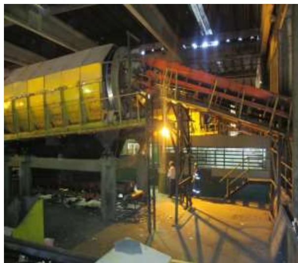
Figura 37 - Local de entrada dos resíduos e alimentação da peneira rotativa primária na UTMB.
