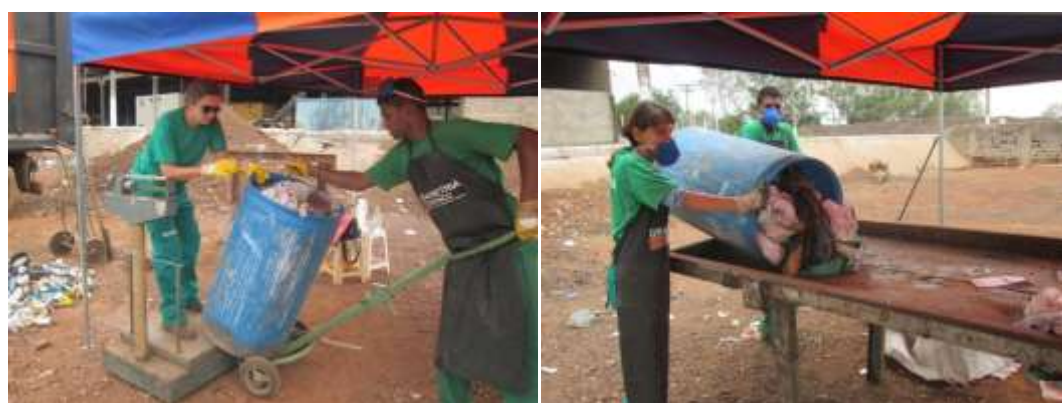
Figura 96 - Pesagem da amostra e despejo na mesa de triagem.
