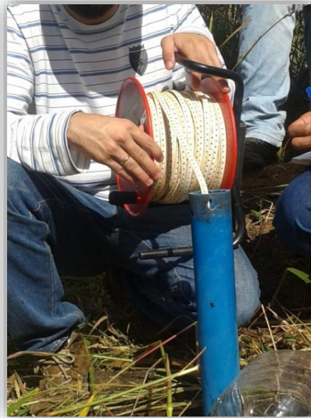
Figura 8 - Medidor de nível
