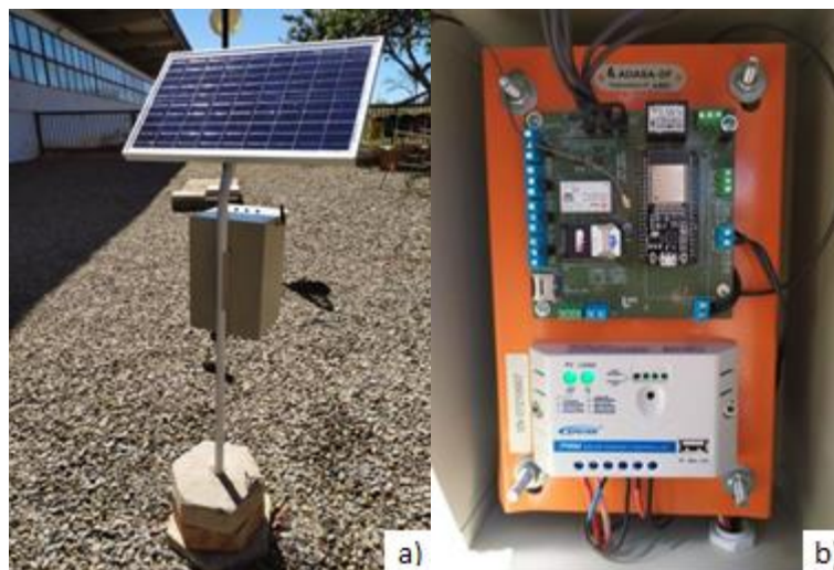
FIGURA 10 – (a) Painel solar acoplado ao datalogger telemétrico que compõe as estações pluviométricas da Adasa; (b) Interior da caixa que reveste o datalogger, placa controladora e placa principal.
