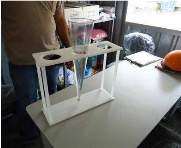
Figura 43 Cone de Imhoff, equipamento usado para determinação do teor de sólidos sedimentáveis da água de drenagem da obra. Fonte: Rosa (2013)
