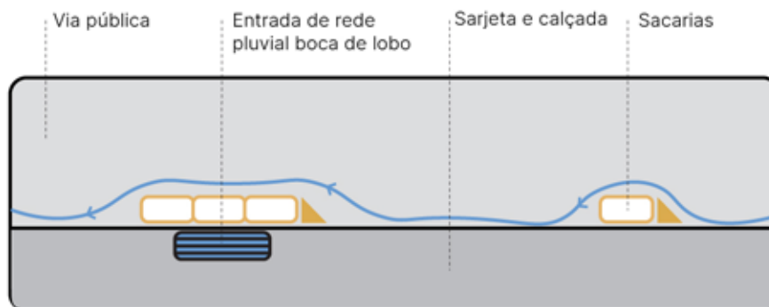
Planta baixa Proteção da entrada da rede pluvial e sistema de retenção de sedimentos com sacarias
