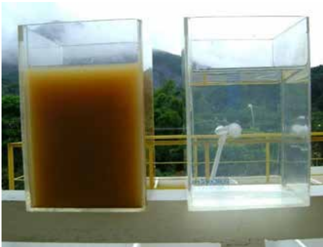
Figura 45 Diferença entre amostras de qualidade de água pluvial após tratamento (antes e após sedimentação). Fonte: Rosa (2019)
