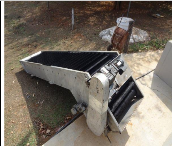
Foto 7 – Grade mecanizada não instalada pela falta da correia transportadora.
