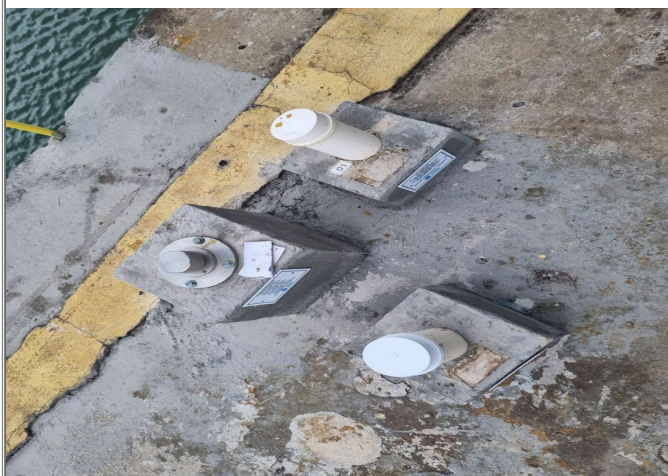
Foto 6 - Piezômetro - PZ - G - 03 - Vertical (Profundidade 18,79m) Piezômetro - PZ - G - 04 - Vertical (Profundidade 10,97m)
