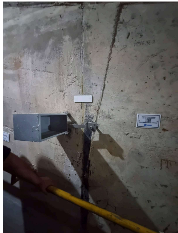
Foto 13 - Extensômetro de Haste - EX - G - 01 - Vertical (Profundidade: 16,00m) - Leitura inicial: 11,37mm
