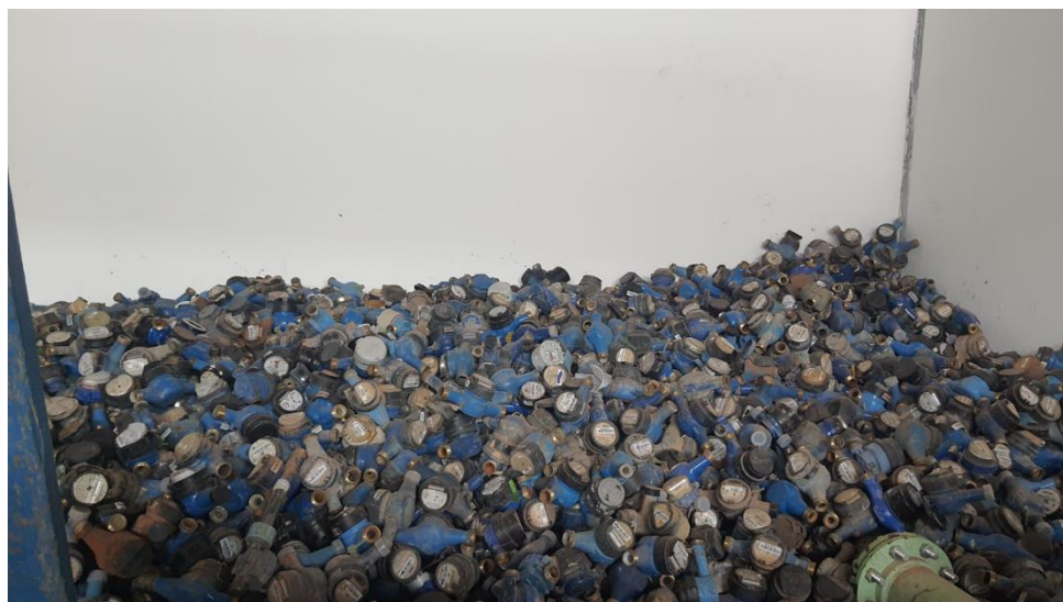
Figura 68 - Hidrômetros retirados e testados
