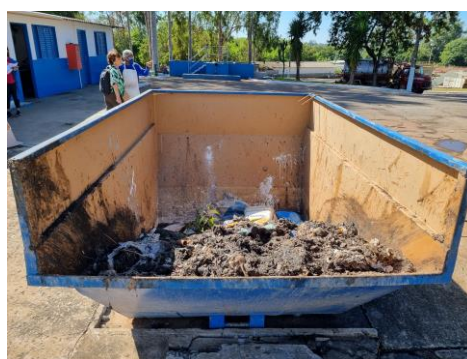
Figura 23 - Caçamba de descarte do material gradeado e retirado manualmente.
