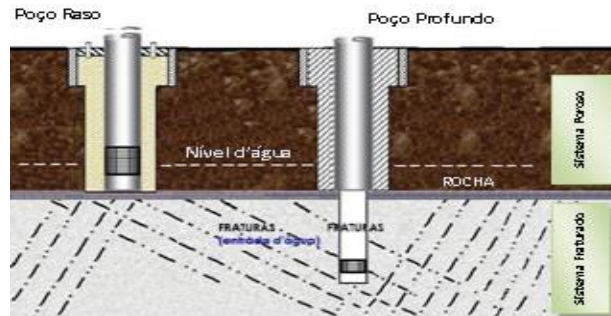
Figura 10 - Perfil esquemático de poço de monitoramento Raso (esquerda) e Profundo (direita)
